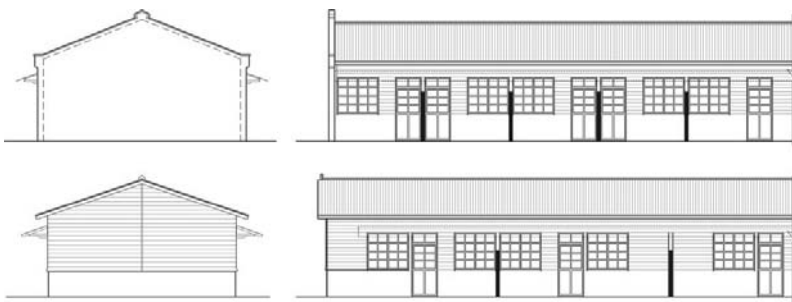
【圖 4-37】眷村建築正立面與山牆型式
