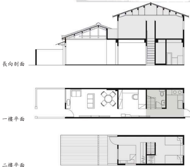
【圖 4-55】眷村增改建案例 A 平面與剖面圖（灰色為增建部分）
