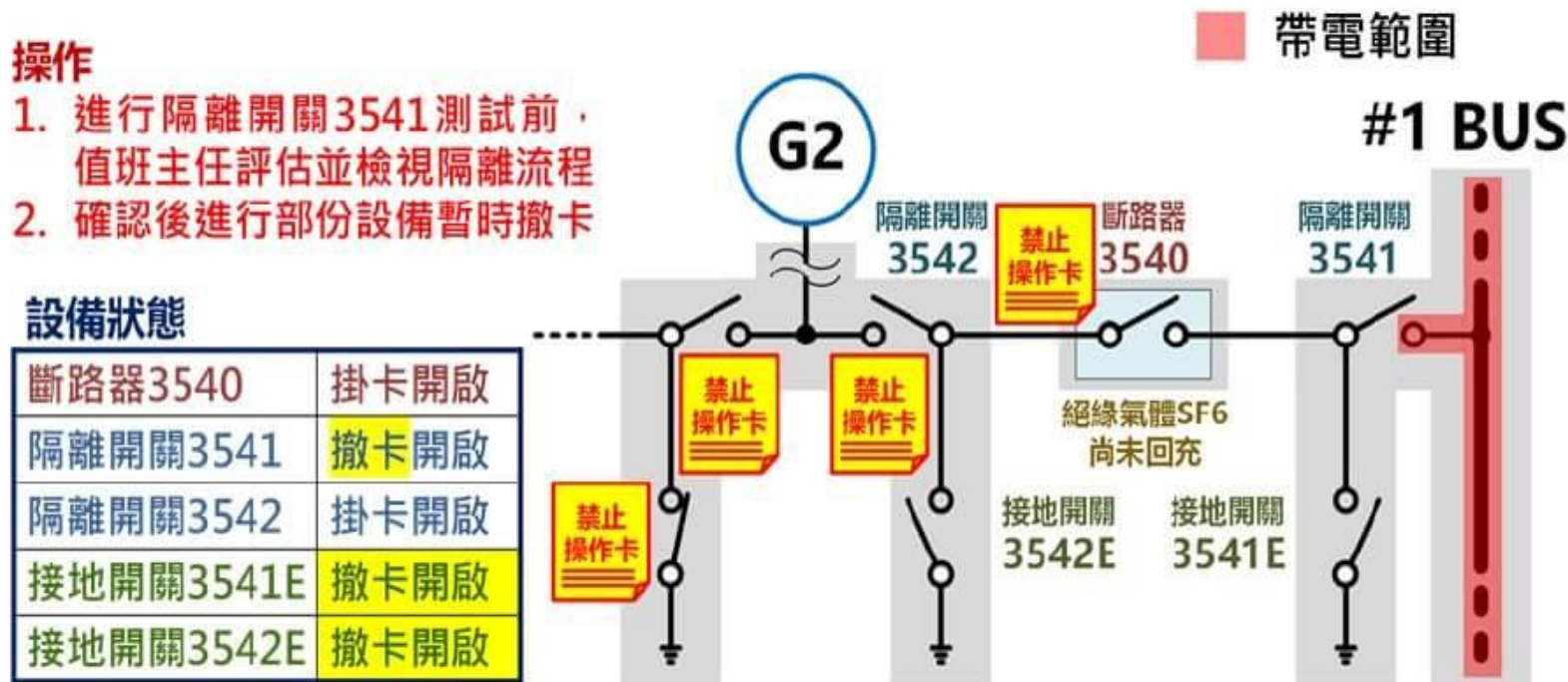
圖 2.5 事故前開關 3541、3541E、3542E 撤卡待測試狀態
