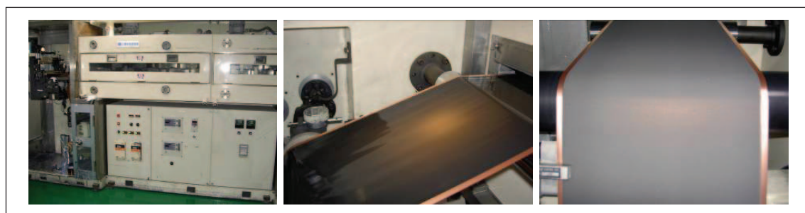
▲圖三 負極漿料塗佈於銅箔烘乾後之照片
