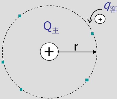
$$\vec{F}_{\text{客}} = q_{\text{客}} \vec{E}_{\text{主}} = \frac{kQ_{\text{主}}q_{\text{客}}}{r^2}$$
